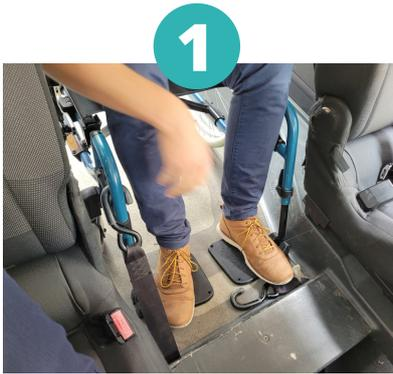
Accrocher le siège à l'avant avec les deux crochets du sol.
