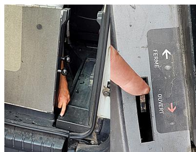
Selon le modèle du véhicule il est possible de déverrouiller ou verrouiller la rampe dans sa position repliée à l'aide d'un bouton latéral.
