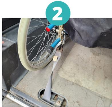
Positionner les deux crochets arrière sur l'armature du fauteuil.
