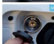
**4/** Connectez le pistolet de charge puis actionnez son verrouillage en relâchant sa poignée.
